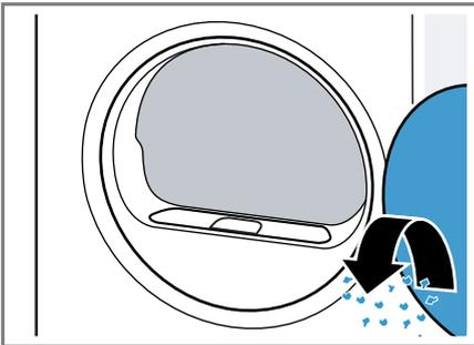
3. Das zweiteilige Flusensieb entfernen.
