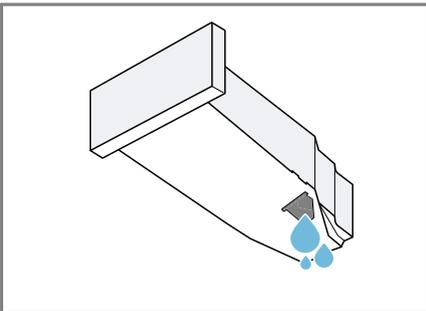
Prüfen Sie regelmäßig den Filter des Kondenswasserbehälters → Seite 43 und reinigen Sie einen verunreinigten Filter.
